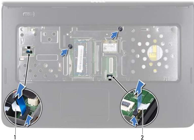
1 Kabel der Betriebsschalterplatine
